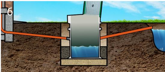
Финальная засыпка песком: уплотнение слоёв через каждые 30 см посредством проливки водой, одновременное заполнение водой Биодевайса. Одновременное заполнение блоков Биодевайса водой: 1 блока- первичного отстойника и 2 блока- зоны нитрификации.
